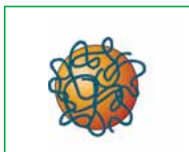
L'additif améliorateur d'Indice de Viscosité se contracte à froid
