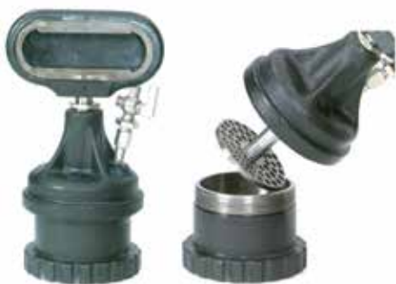
Illustration 1 : Test ASTM D217 - Malaxeur de graisse
