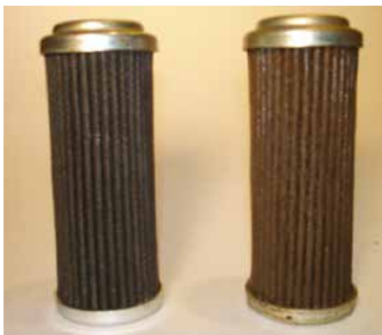
Exemple de filtres hydrauliques : propre / encrassé
