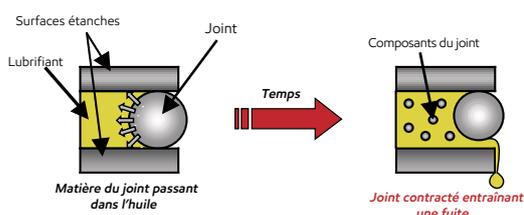
**Joint gonflé :** les composants du lubrifiant passent dans le joint. Le gonflement modéré d'un joint n'est pas alarmant, contrairement à un gonflement
