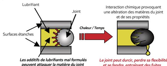
Les performances d'un joint peuvent être affectées par des températures élevées qui peuvent accélérer la réaction chimique, mais aussi par la présence de poussières / impuretés et d'autres contaminants qui peuvent user prématurément le joint d'étanchéité. Il est donc essentiel que le lubrifiant et le joint d'étanchéité soient aussi compatibles que possible pour optimiser l'efficacité du système.
