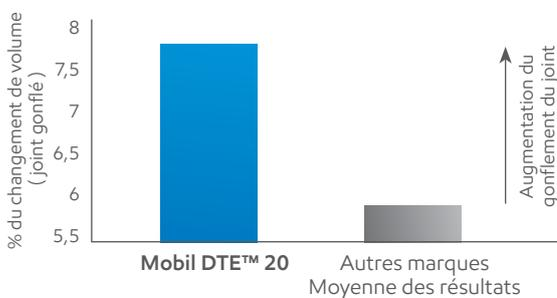
Ces tests montrent que la gamme Mobil DTE™ 20 est conçue pour assurer un gonflement nécessaire des joints d'étanchéité dans la limite des prescriptions des fabricants. Cette faculté contribue à réduire les fuites d'huile dues aux interactions huile / joints d'étanchéité.
