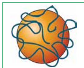
L'additif améliorateur d'Indice de Viscosité se dilate à chaud
